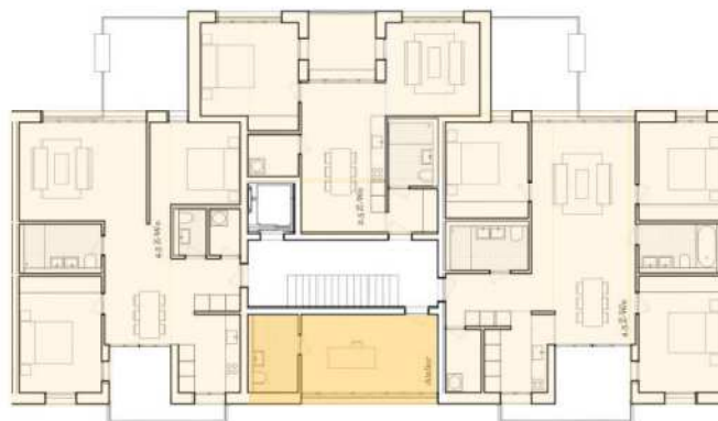
Abbildung 19: Projekt Unterfeld Süd in Baar von Implenia Schweiz AG – Wohnüberbauung Anlage – Gewerberaum mit Nasszellen ausserhalb der Wohnung
