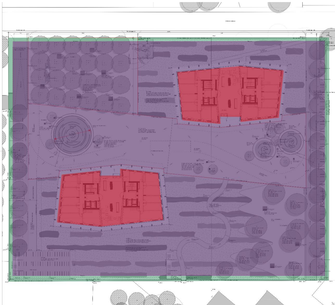
Abbildung 7: Schema Über-/ Unterbauung Metropolitans
