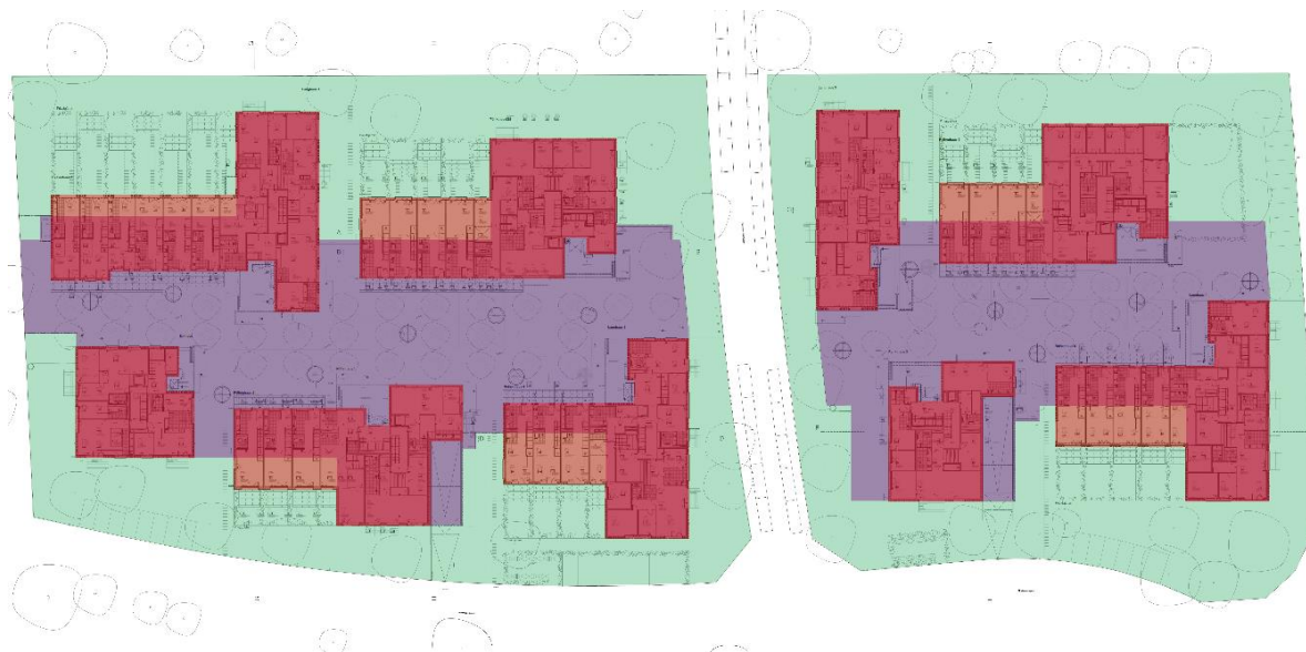
Abbildung 8: Schema Über-/ Unterbauung Arealüberbauung Altwiesen
