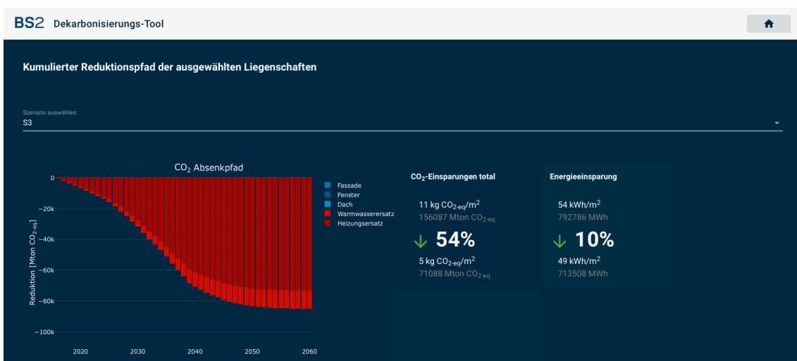
Abbildung 16: Absenkpfad nur Wärmeerzeugersersatz, Szenario 3 – geringe CO 2 -Intensität
