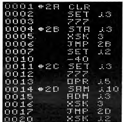
Abb. 4. Programmwiedergabe im Anzeigegerät (Kathodenstrahl-oszillograph).
