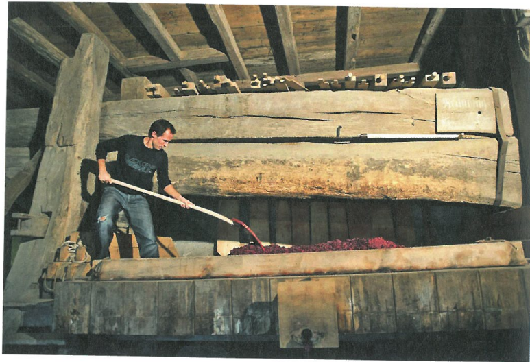
59 Weinbau-Tradition auf dem Ottenberg: Die aus Eichenholz gebaute Weinpresse im Schlossgut Bachetobel stammt aus dem Jahr 1584 und gilt als älteste noch betriebene Kelteranlage in der Schweiz. Sie ist 11 Meter lang, 3,5 Meter tief und 4,5 Meter hoch. Im Bild wird die Traubenmeische auf dem Preststisch ausgebreitet und anschliessend mit Brettern abgedeckt, bevor sich die Presse darauf senkt. Foto 2012.
