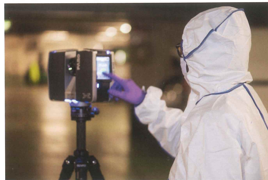
Abbildung 3: Einsatz eines 3D-Laserscanners vor Ort durch das FOR.
