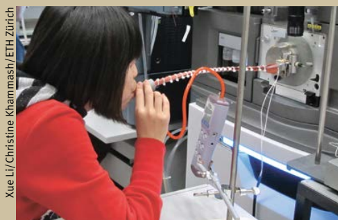
Der Atemtest mit dem Massenspektrometer erlaubt, Lungenerkrankungen zu erkennen.
