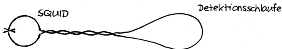
Wird der SQUID in der weiter oben besprochenen Weise benutzt (siehe "*Bemerkungen zu SQUID's*"), bei der einzelne Flussquanten gezählt werden können, spricht man von sog. *DC SQUID'S*. Aus technischen Gründen verwendet man üblicherweise sog. *RF-SQUID'S*, welche robuster in ihrer Anwendung als DC SQUID'S sind, aber auch etwas weniger empfindlich.
