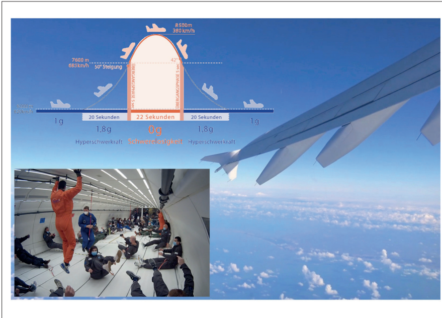
Abb. 1: Zum Parabelmanöver beschleunigt die Maschine maximal und wird dann steil (bis 50°) in den Himmel gezogen, wobei sich die Schwerkraft in der Maschine fast verdoppelt. Dann wird sie in freien Fall versetzt (angekündigt durch "injection"), wobei für 22s Schwerelosigkeit entsteht. Beim Abfangen (angekündigt durch "pull out") entstehen wieder für ca. 20s 1,8g im Flugzeug.
