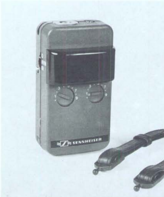
Abb. 7 Ansicht des Schülerempfängers. Auch der Empfänger ist mit einem Elektretmikrofon versehen und gleichzeitig ein akustisches Hörgerät. Durch den seitlichen Schalter kann man wählen, ob das Mikrofon dauernd zugeschaltet werden soll oder ob es automatisch nur dann eingeschaltet werden soll, wenn aus irgendwelchen Gründen die Lichtübertragung unterbrochen ist.
