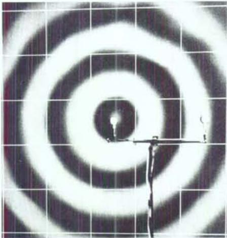
Abb. 4 Schallfeldaufnahme eines Kugelstrahlers. Phasendarstellung.  $f = 3,4$  kHz.
