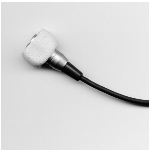
Bild 8: Mikrofon mit Gehörschutz zum Abdichten gegen Störschall im OP
